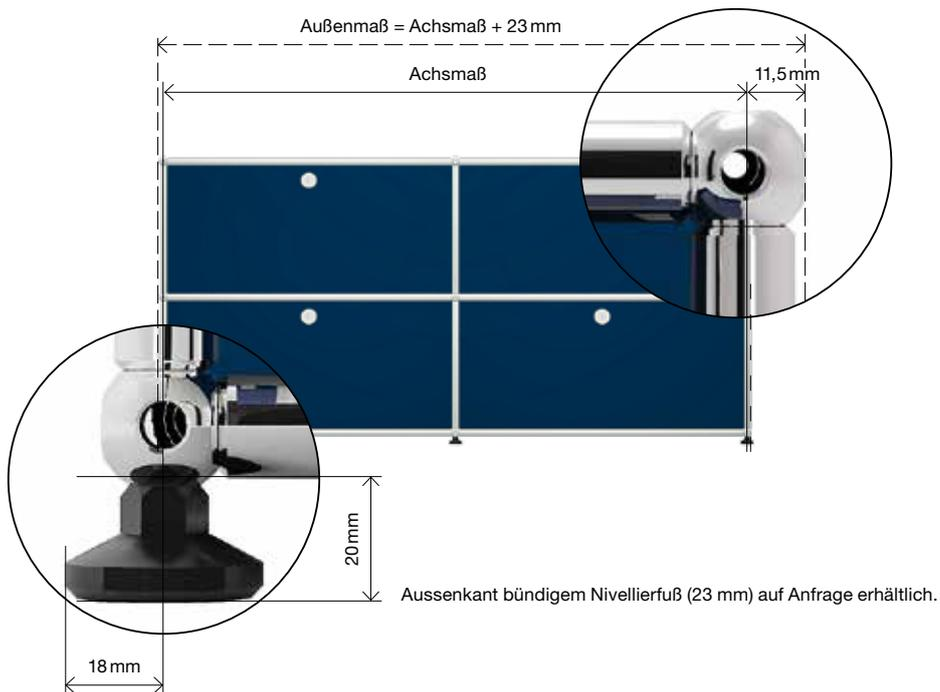
Das USM Haller Möbelbausystem bietet eine Vielzahl von Elementen in Standardgrößen an. Höhen, Breiten und Tiefen sind erhältlich in den Maßen wie unten aufgeführt. Alle Angaben als Achsmaße in mm.
