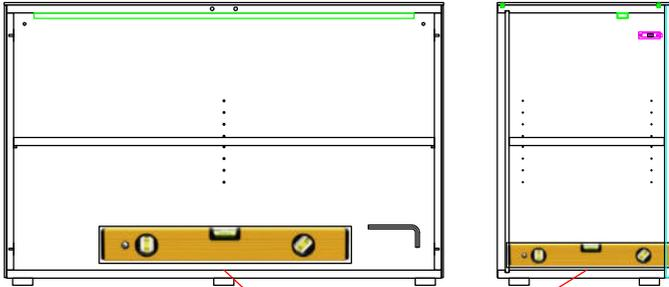
1. Ausrichten mit Wasserwaage und Inbusschlüssel
