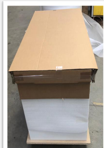
Container wird von unten durch die Bodenplatte geschützt, von oben durch einen separaten Kartondeckel mit Kantenschutz
