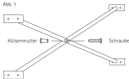
2. Legen Sie einen Seitenrahmen – Stanzvertiefungen nach unten – auf den Boden oder auf einen Tisch und stellen Sie die Kreuzstreben so auf den Seitenrahmen, dass die Bohrungen des Kreuzes über denen der Seiten liegen. (Abb. 2) Falls das nicht der Fall ist, drehen Sie bitte das Kreuz um die Schrauben 180° weiter.
