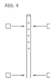
3. Zum Schluss verschrauben Sie den zweiten Seitenrahmen oben mit den Kreuzstreben. Unten schließen Sie das Stahlrohr mit den beiliegenden schwarzen Abschlusskappen aus Kunststoff (keinesfalls die Gummikappen) oder Sie verwenden bei Bodenunebenheiten den Niveauequalisiersatz. Oben sind ebenfalls Abschlusskappen – alternativ übrigens in Gummi ...bitte mit einem Tropfen Spülmittel/Gleitmittel einsetzen – oder in der Regel die Verlängerungsstäbe.
