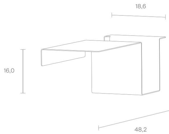
Die Seitenablage wird direkt auf die Längsseite des Bettes aufgesteckt.
