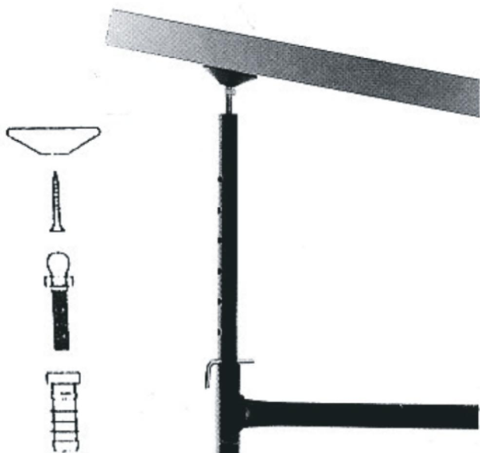
Um die Tischplatte in Höhe und Neigung verstellbar zu machen, muss sie mit den hintenliegenden Verlängerungsstäben fest verschraubt werden. Vorne liegt die Platte lose auf den Gelenktellern. Die untere Ablageplatte kann mit vier Schrauben befestigt werden.
