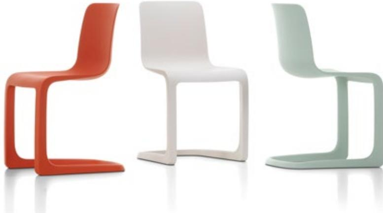
Mit EVO-C ist es gelungen, das Prinzip und die Merkmale des klassischen Freischwingers kompromisslos in Kunststoff zu übersetzen. Das Gasinnendruckverfahren beim Spritzgiessen von Kunststoffen macht es heute möglich, die Festigkeit von bewährten Stahlrohr-Freischwingerkonstruktionen zu erreichen. Die tragende Struktur wird dabei durch Hohlkörper mit Rohreigenschaften gebildet, und die flächigen Geometrien von Sitz und Rücken können fließend und nahtlos daran angeschlossen werden.
