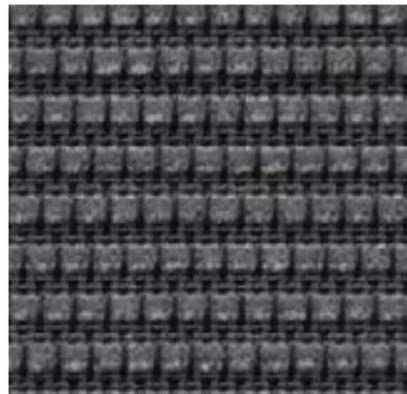
FleeceNet ist ein technisches Netzgewebe aus Polyester und Polyamid mit einem eingewebten Chenillegarn. Weil FleeceNet keine geschlossene Fläche bildet, ist es atmungsaktiv und fördert ein angenehmes Sitzklima. Das Verweben unterschiedlicher Garne erlaubt frische Farbkombinationen.
